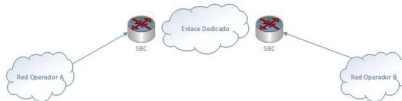
Figura 1. Topología de interconexión SBC-SBC
