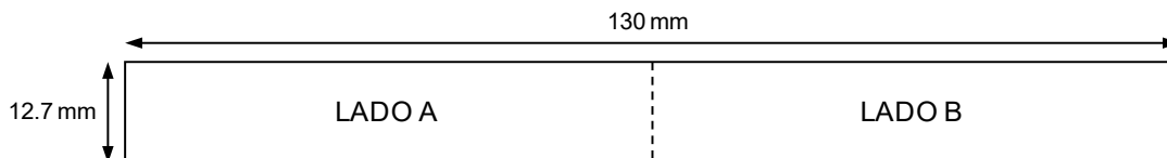
Figura 3.- Dimensiones de la etiqueta para cables multipar.
