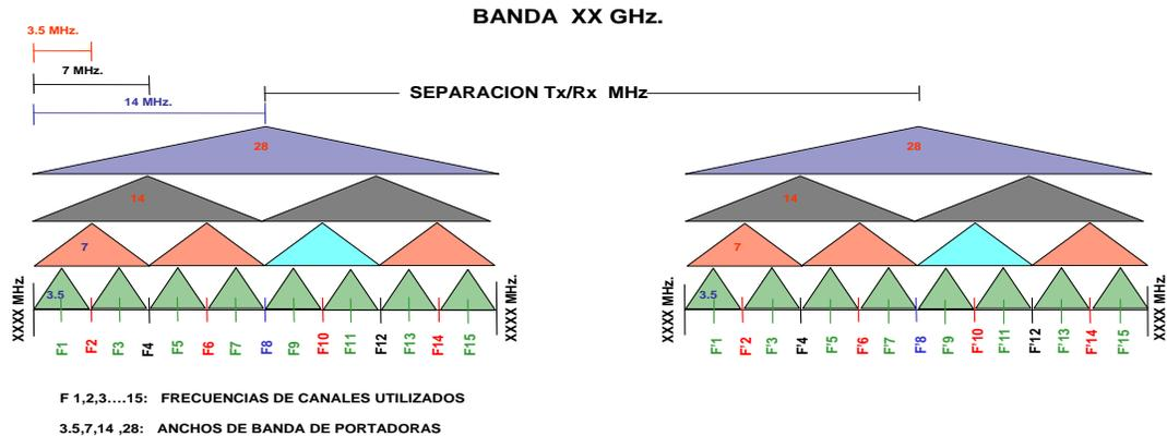
Figura 1. Plan de canalización
