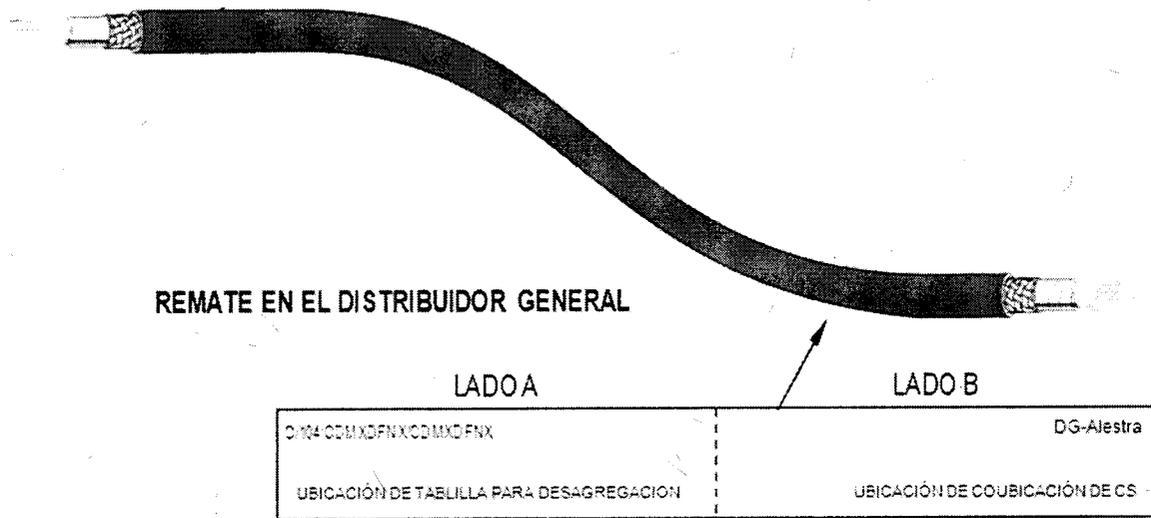
Figura 5.- Ejemplo de etiqueta para cables multipar.
