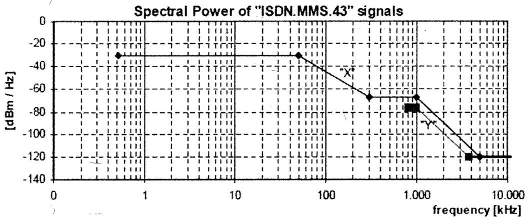
**Figura 7 Potencia espectral para señales ISDN MMS43 PRI.**
