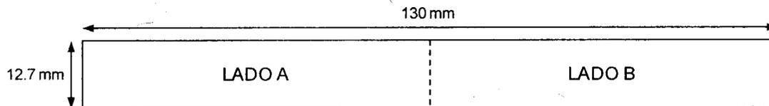
Figura 3.- Dimensiones de la etiqueta para cables multipar.
