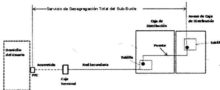
Figura 2. Servicio de Desagregación del Sub-Bucle Local.
