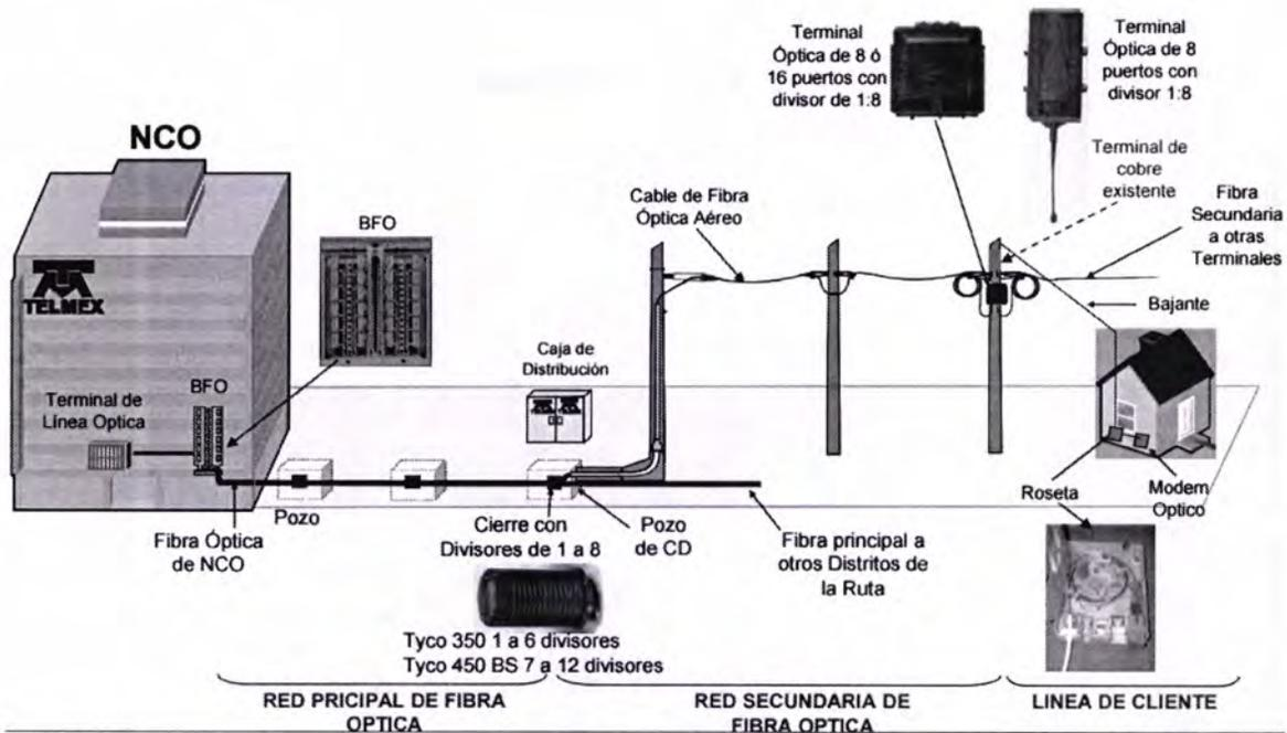
Figura .9: Topología de la Red de Fibra Óptica a la Casa [Fuente: Telmex<sup>16</sup>, 2015]
