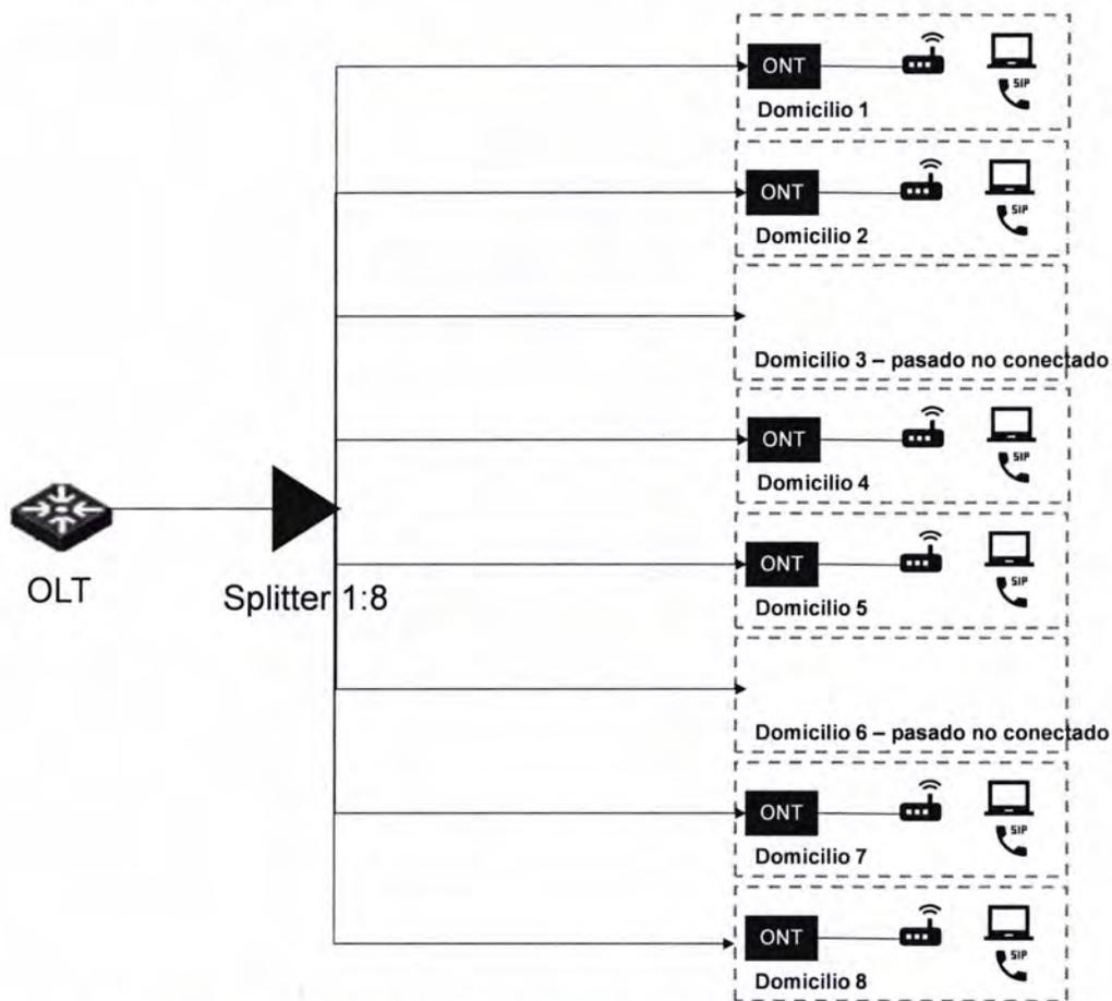
Figura 5: Estructura de red GPON simplificada [Fuente: elaboración propia]
