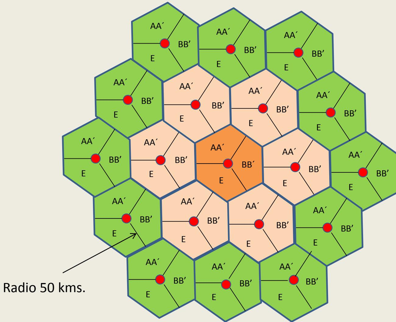
**División en 5 la cantidad de canales por participante para quedar Conformado el re uso de frecuencias en 5 Sub bloques en modo dúplex y 5 en modo simplex respetando la cantidad de canales que corresponde de acuerdo a la propuesta**
