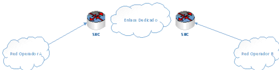
• Figura 1: Topología de interconexión SBC-SBC
