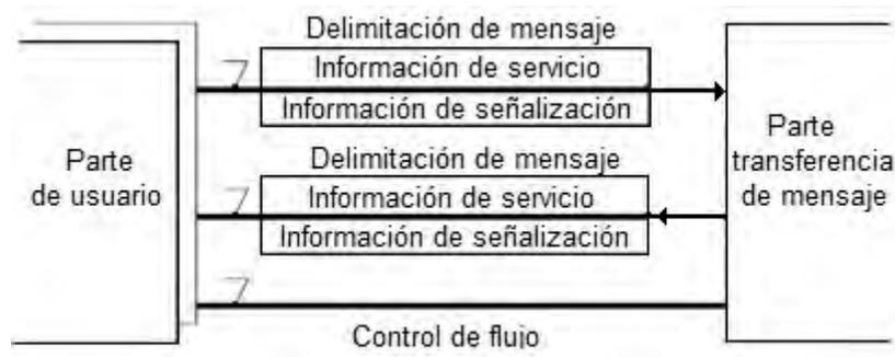
**FIGURA 16.- Interfaz funcional entre la parte de transferencia de mensaje y las partes de usuario.**
