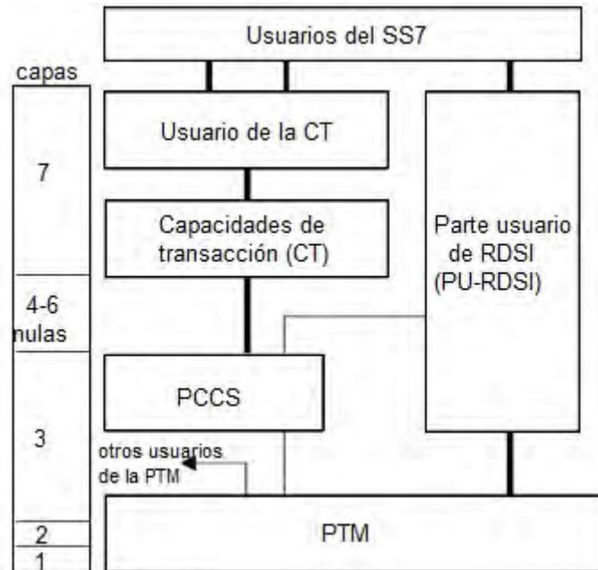
FIGURA 2.- Arquitectura del sistema de señalización N.º 7.
