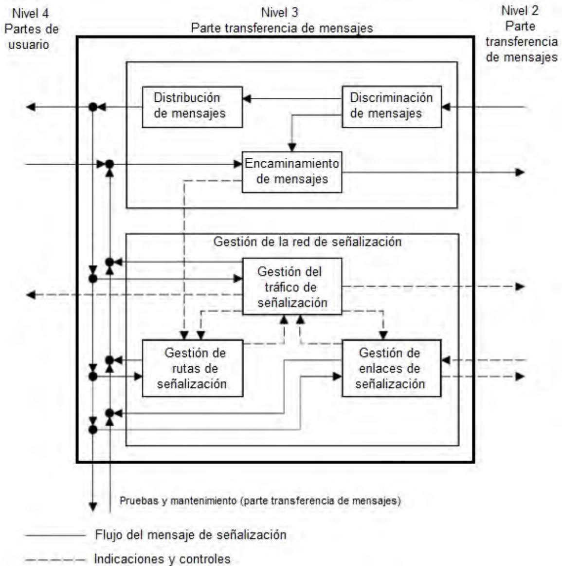
FIGURA 24.- Funciones de la red de señalización.
