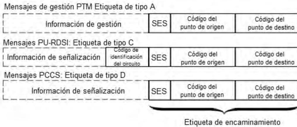
FIGURA 10.- Tipos de etiqueta de mensajes de SS7.
