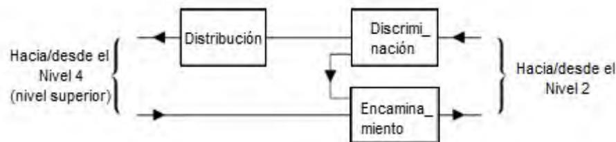
FIGURA 25.- Encaminamiento, discriminación y distribución de mensajes.
