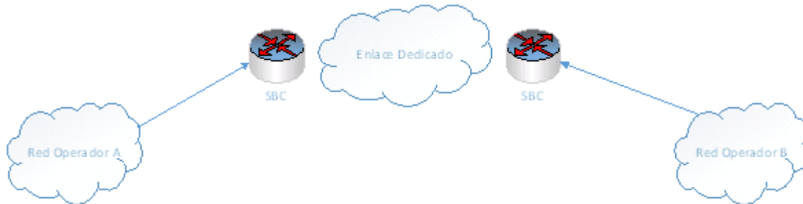
• Figura 1: Topología de interconexión SBC-SBC
