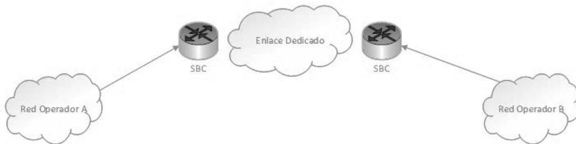
Figura 1. Topología de interconexión SBC-SBC
