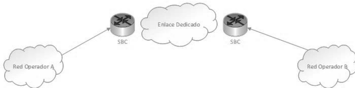
Figura 1. Topología de interconexión SBC-SBC
