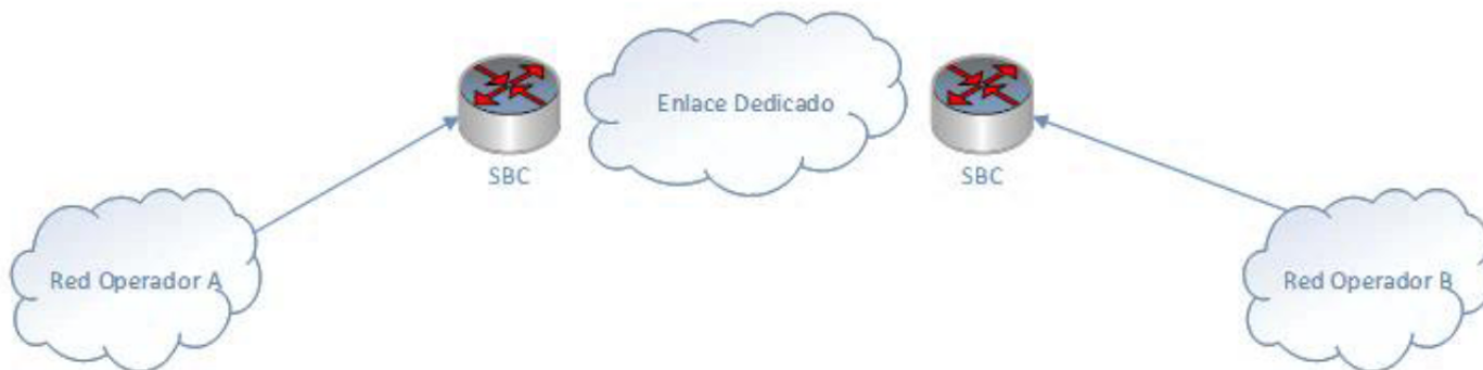
Figura 1. Topología de interconexión SBC-SBC
