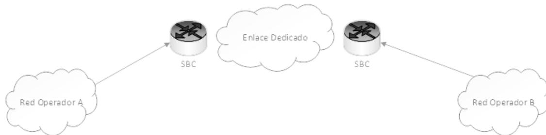
Figura 1. Topología de interconexión SBC-SBC
