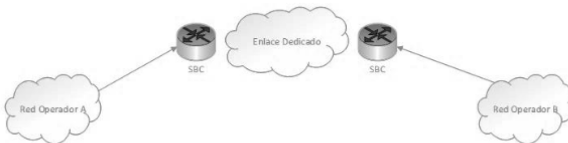
Figura 1. Topología de interconexión SBC-SBC
