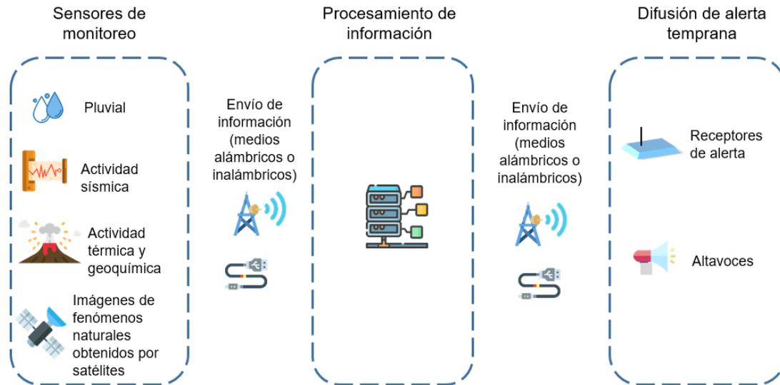
Figura 1. Diagrama de bloques de sistemas de alerta temprana
