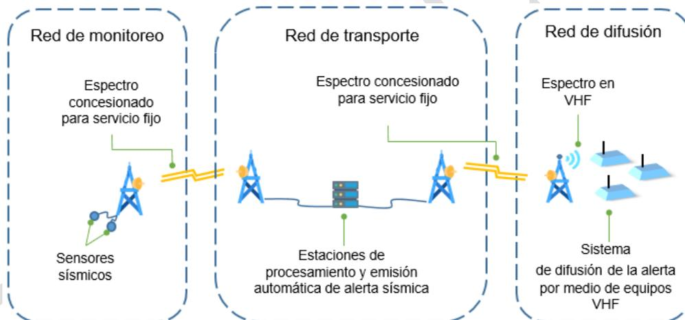
Figura 6. Esquema de distribución del sistema de alerta sísmica, elaborado por el Instituto.
