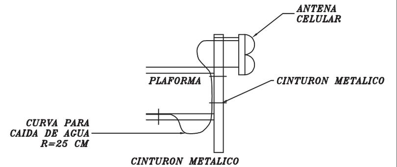
**FIJACION DE FEEDERS Y JUMPER EN PLATAFORMA**
