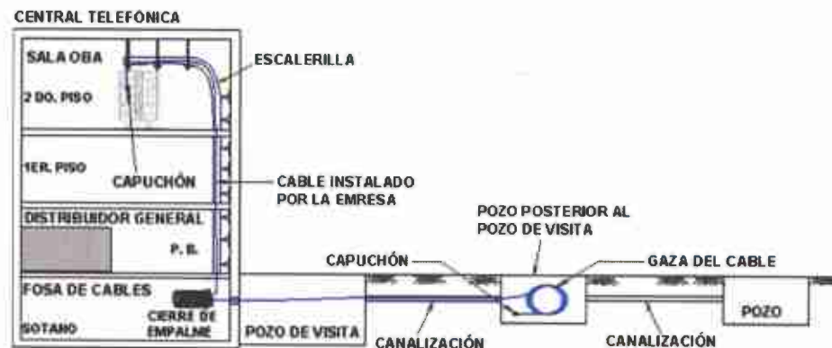
Figura 4. Recorrido del cable instalado por Telmex en la central para los Concesionarios Solicitantes.
