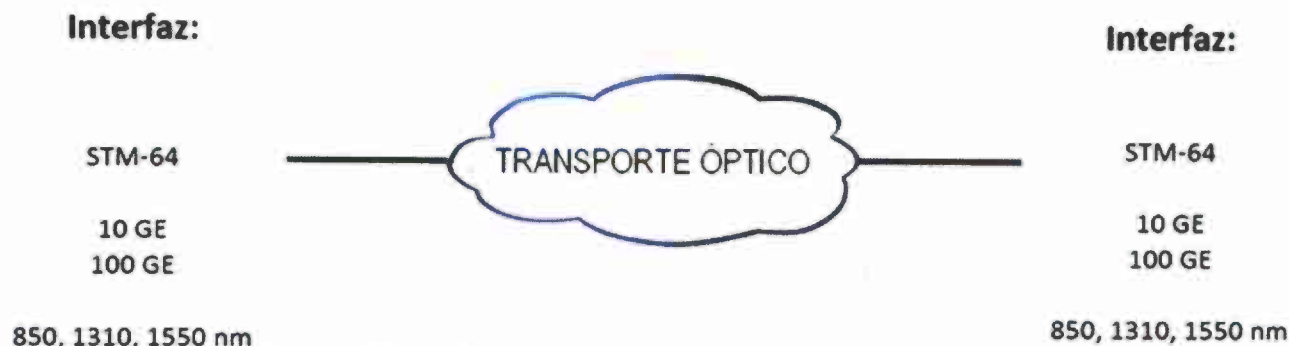
Figura 3 Arquitectura del servicio de canal óptico.
