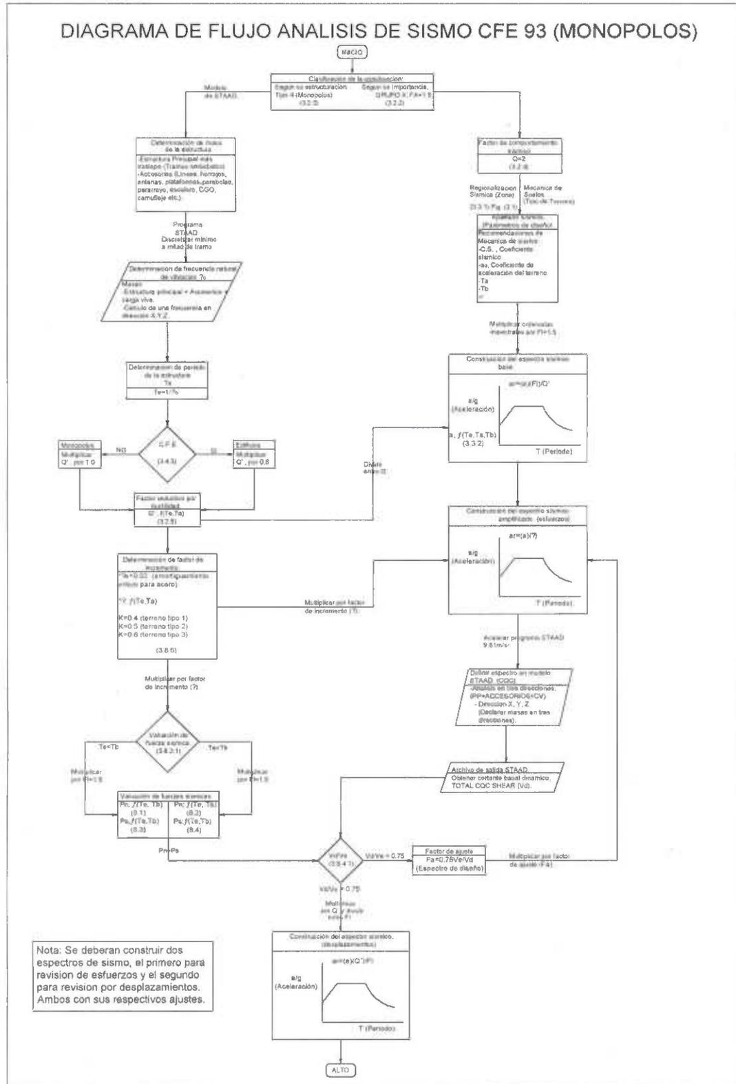
Nota: Se deberán construir dos espectros de sismo, el primero para revisión de esfuerzos y el segundo para revisión por desplazamientos. Ambos con sus respectivos ajustes.
