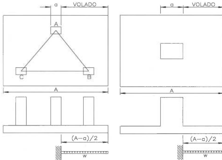
El valor de las presiones de contacto  $q_{\text{diseño}}$  que se utilizarán para el cálculo del momento de diseño será el resultante del  $q_{\text{act}}$  por su factor de carga correspondiente (sin considerar el peso de relleno).
