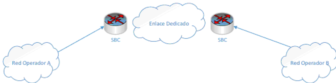
Figura 1: Topología de interconexión SBC-SBC
