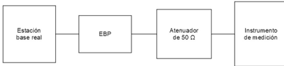
Figura 1. Configuración para medición de emisiones conducidas.
