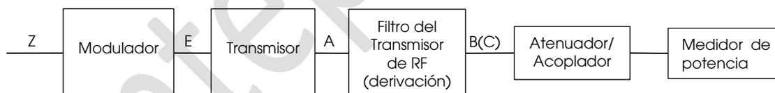
Figura 6. Configuración de prueba conducida para la potencia máxima de RF.
