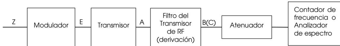
Figura 7. Configuración de prueba conducida para la exactitud en frecuencia.
