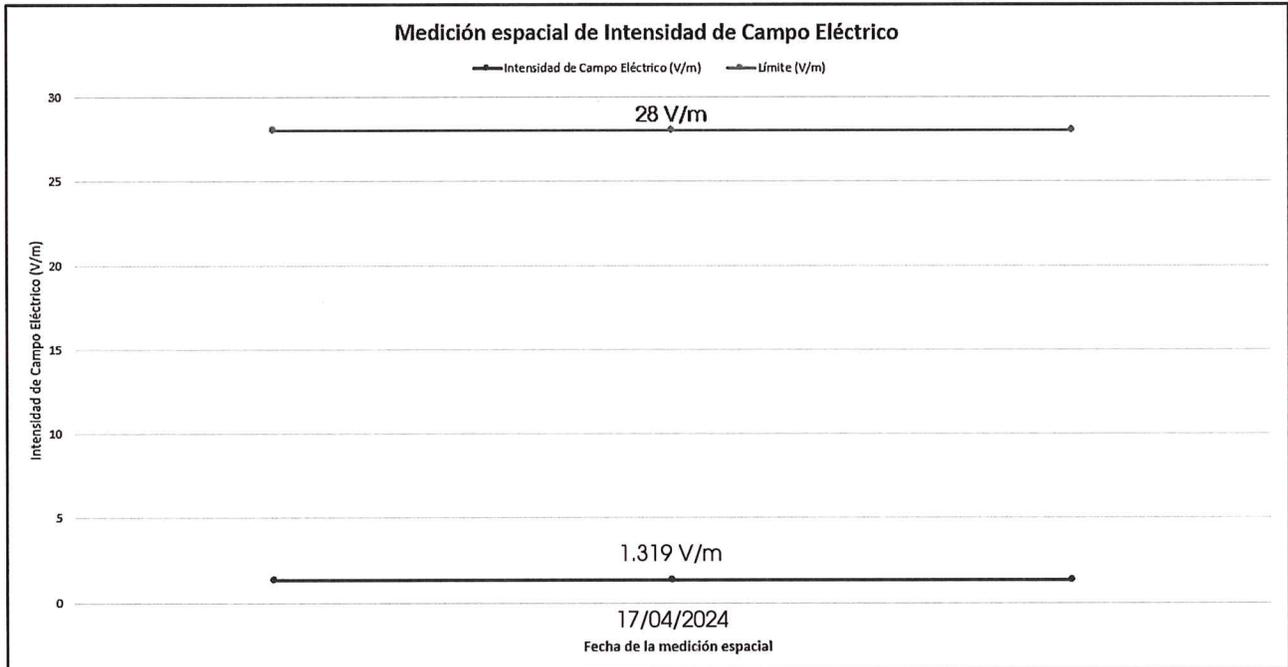
Imagen 7. Comparativo entre el valor espacial obtenido en el punto de medición 22 y el límite para campo eléctrico 28 V/m para exposición poblacional.
