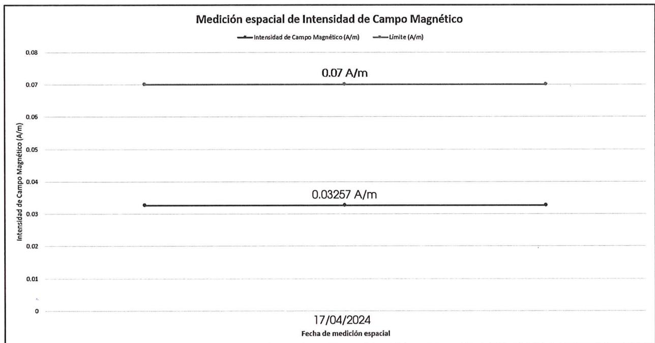
Imagen 8. Comparativo entre el valor espacial obtenido en el punto de medición 22 y el límite para campo magnético 0.073 A/m para exposición poblacional.
