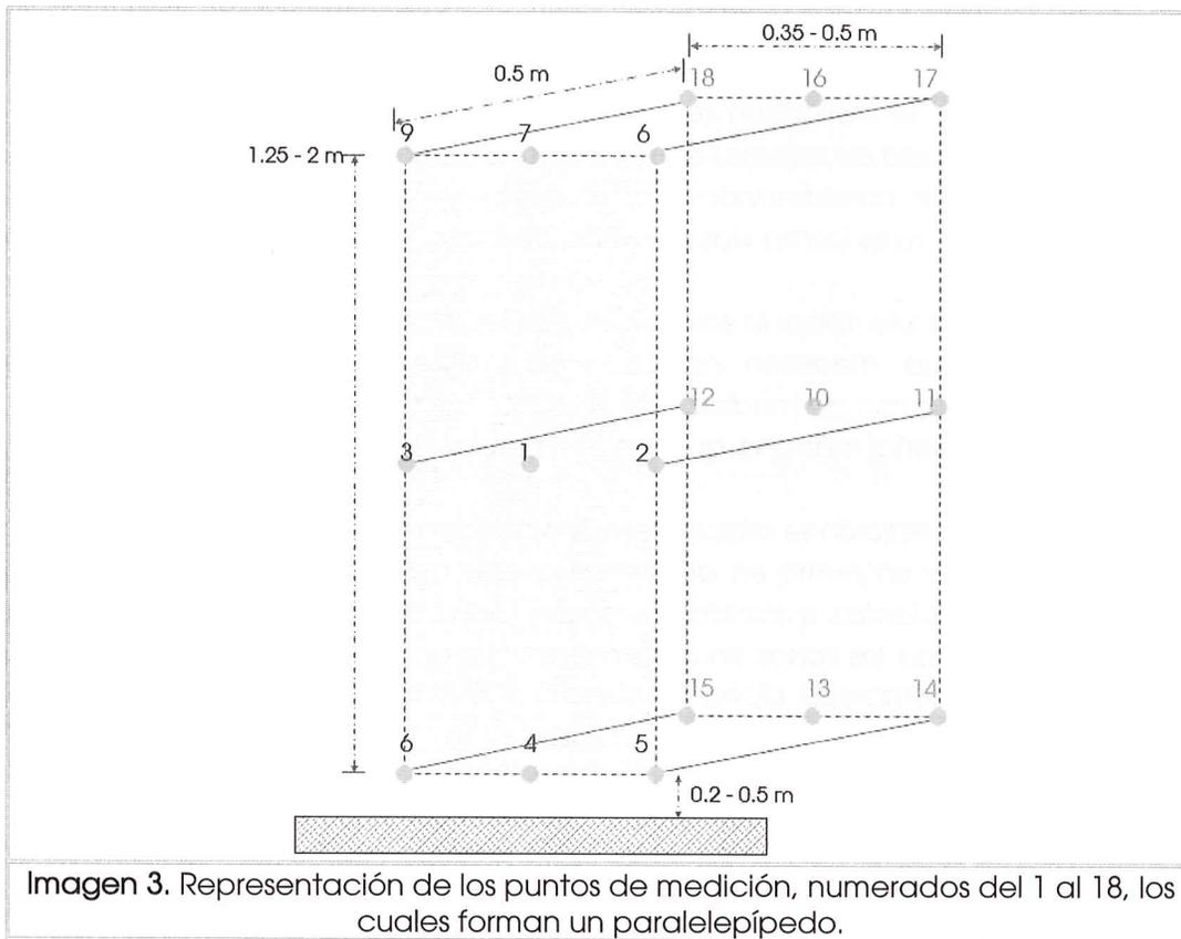
B.4 Previo al inicio de la medición, el operador se debe mantenerse alejado del equipo de medición, con la finalidad de no perturbar el campo electromagnético en el entorno a evaluar, además de asegurar que en las inmediaciones no se encuentre elementos conductores.<sup>14</sup>
