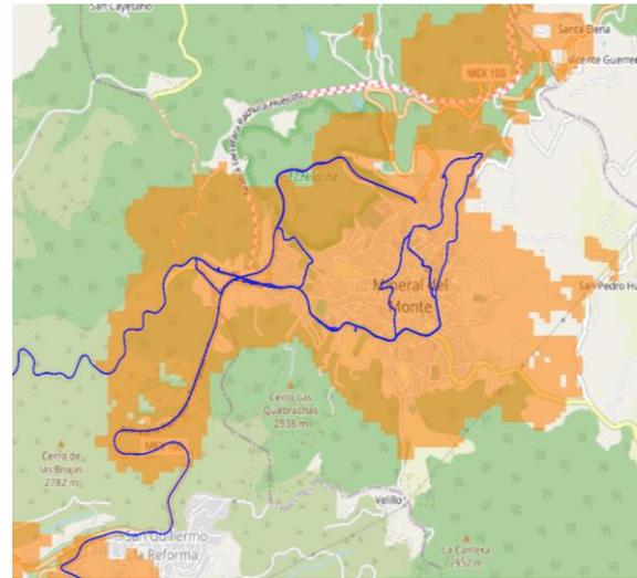
**Imagen 3).** Mapa resultante de la intersección de la cobertura garantizada y recorrido de medición para la tecnología de acceso 3G, de todos los Concesionarios y OMV, en i) Pachuca de Soto y Mineral de la Reforma, ii) Ixmiquilpan, iii) Tepeji del Río de Ocampo, iv) Tula de Allende, v) Atotonilco de Tula, vi) Tulancingo de Bravo, vii) Tizayuca, y viii) Mineral del Monte.
