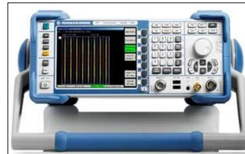
Imagen 2. EMT y ETL TV Analyzer
