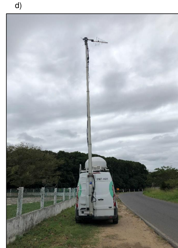
Imagen 3. Posicionamiento de la EMT en el punto de medición número 13. a) Vista trasera derecha, b) Vista frontal, c) Vista lateral derecha, d) Vista trasera
