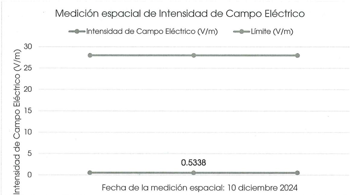
Imagen 7. Comparativo entre el valor espacial obtenido en el punto de medición 12 y el límite para campo eléctrico 28 V/m para exposición poblacional.
