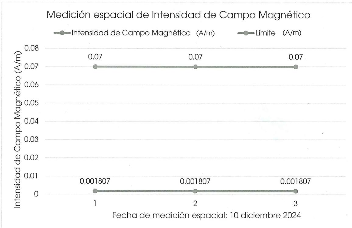
Imagen 8. Comparativo entre el valor espacial obtenido en el punto de medición 12 y el límite para campo magnético 0.001807 A/m para exposición poblacional.
