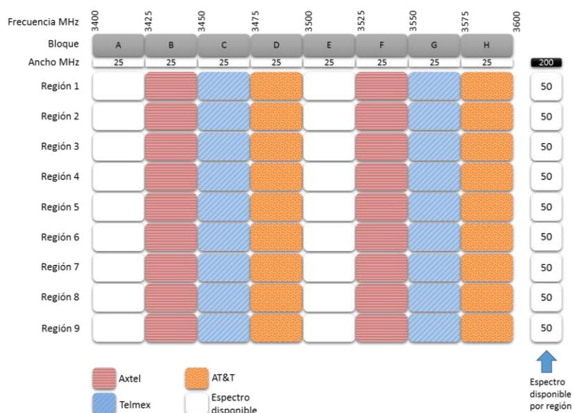
Figura 1 Gráfica de tenencia actual del espectro radioeléctrico del servicio de acceso inalámbrico fijo o móvil.
