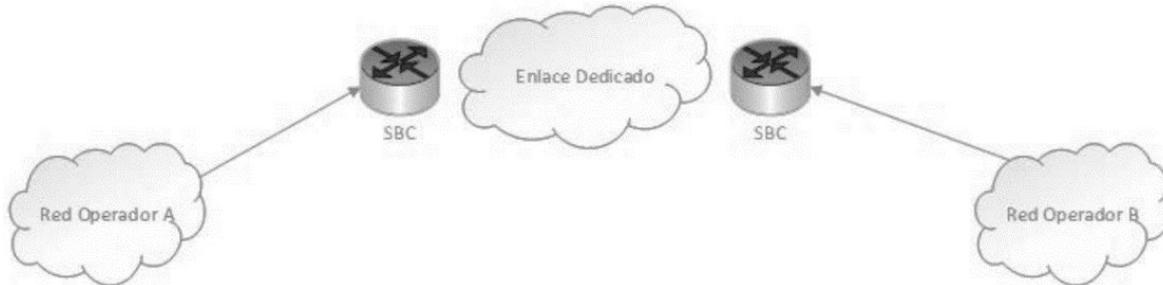
Figura 1. Topología de interconexión SBC-SBC
