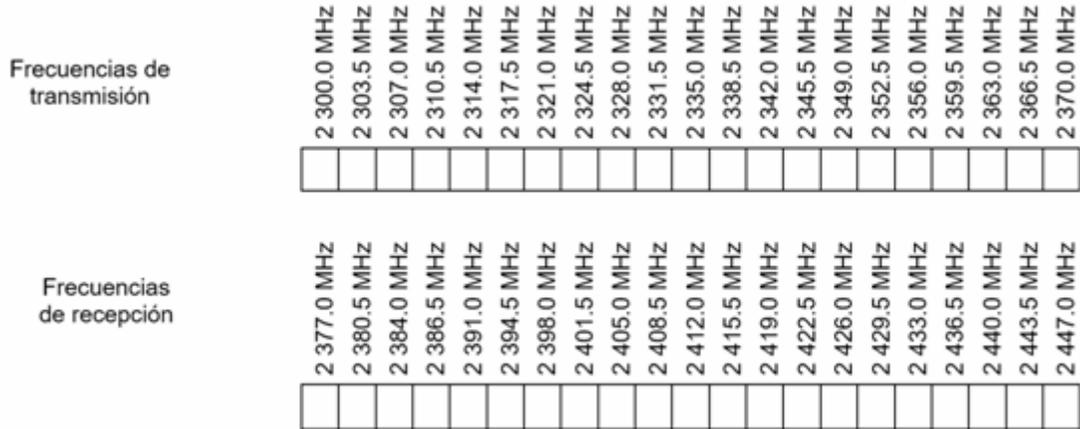
Figura 1. Banda de frecuencias y su canalización.
