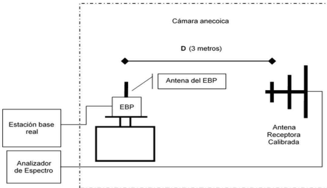
Figura 3. Configuración para medición de emisiones radiadas.
