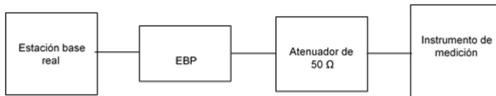
Figura 2. Configuración para medición de emisiones conducidas.
