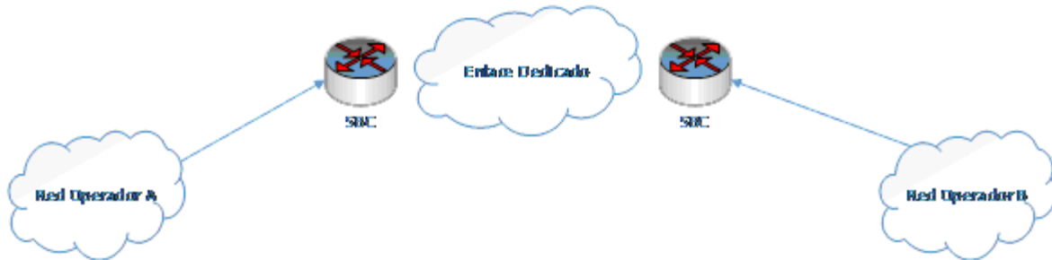
Figura 1: Topología de interconexión SBC-SBC
