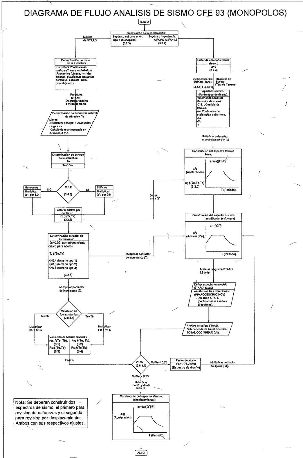
Nota: Se deberan construir dos espectros de sismo, el primero para revision de esfuerzos y el segundo para revision por desplazamientos. Ambos con sus respectivos ajustes.
