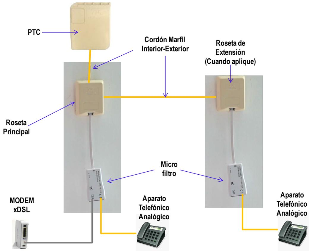
Figura 2. Esquema de la Red interior del Usuario.
