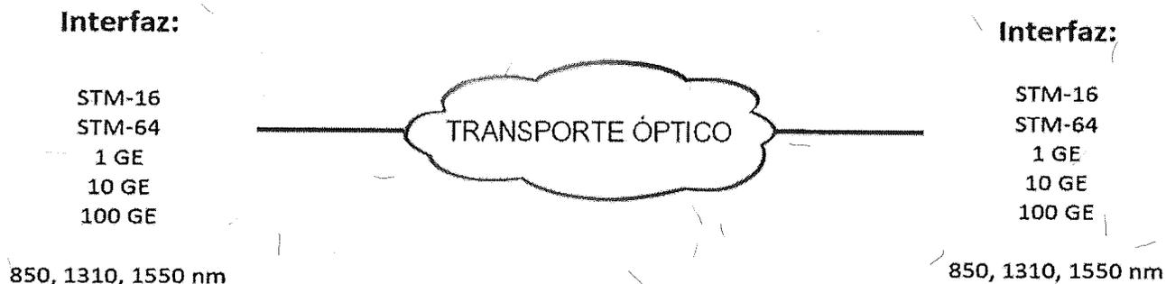
**Figura 3 Arquitectura del servicio de canal óptico.**
