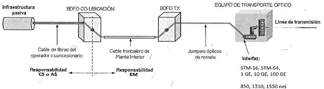
**Figura 4 Conexión del servicio de canal óptico.**
