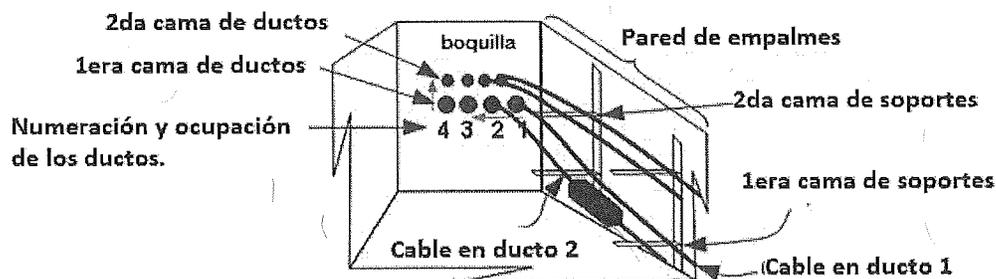
Figura 3 Diagrama de ductos dentro de un pozo
