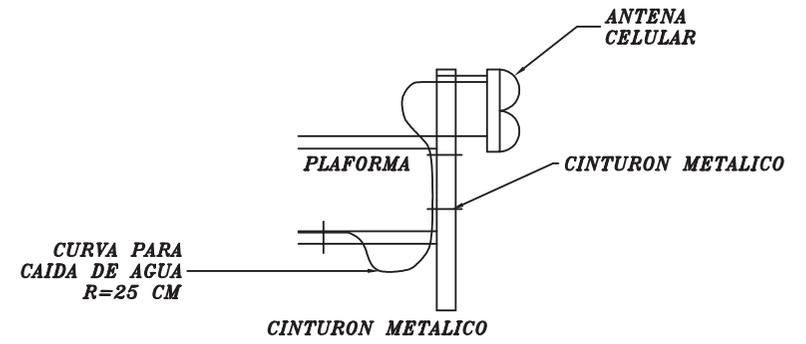
**FIJACION DE FEEDERS Y JUMPER EN PLATAFORMA**
