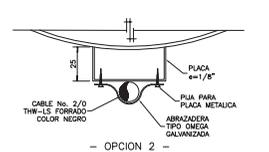
**DETALLE DE SUJECION PARA CABLE DE PARARRAYOS**
