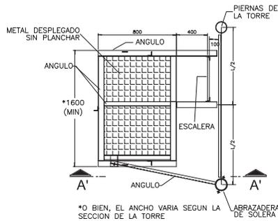
\*O BIEN, EL ANCHO VARIA SEGUN LA SECCION DE LA TORRE
