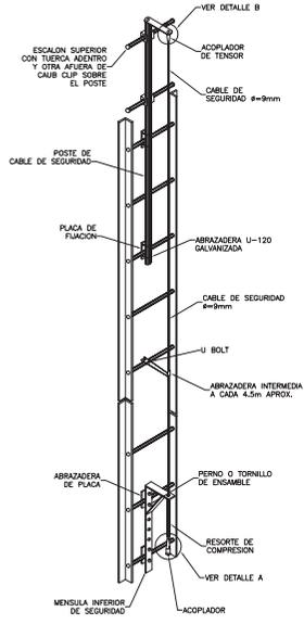
**ESQUEMA DE DISPOSITIVO DE SEGURIDAD MCA. MICROFLECT**
