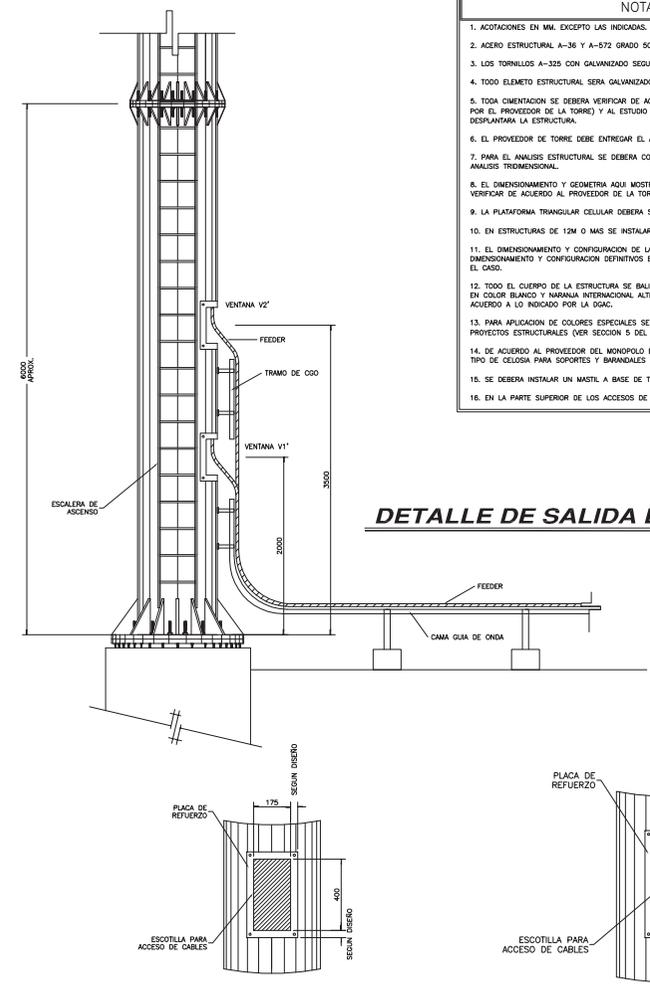
**DETALLE DE SALIDA DE FEEDERS**
