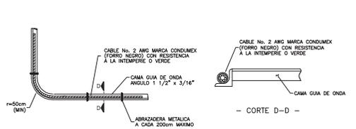
**DETALLE DE SUJECION DE CABLE PARA ATERRIJAZE DE FEEDERS A CAMA GUIA DE ONDA**
