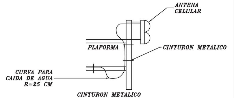
**FIJACION DE FEEDERS Y JUMPER EN PLATAFORMA**
