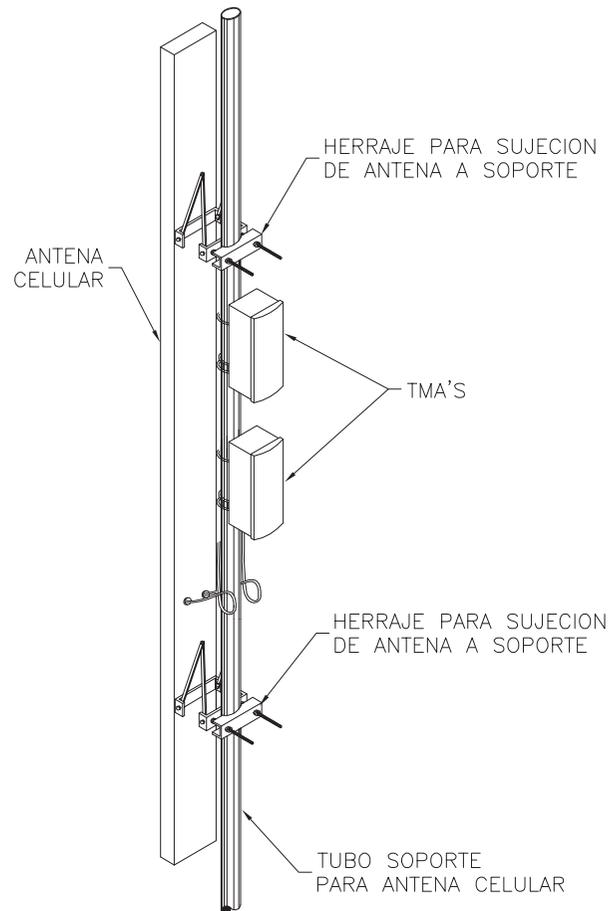
EL HERRAJE PARA SUJECION DE ANTENA A SOPORTE (TUBO  $\phi=2''$  CED. 40) PODRA SER DE VARIAS FORMAS DEPENDIENDO DEL FABRICANTE DE LA ANTENA, SIEMPRE Y CUANDO CUMPLA CON LAS SIGUIENTES CONDICIONES:
