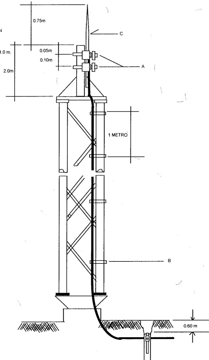
Conexión de Puesta a Tierra del Pararrayos en Torres de Microondas menores de 30.5m
