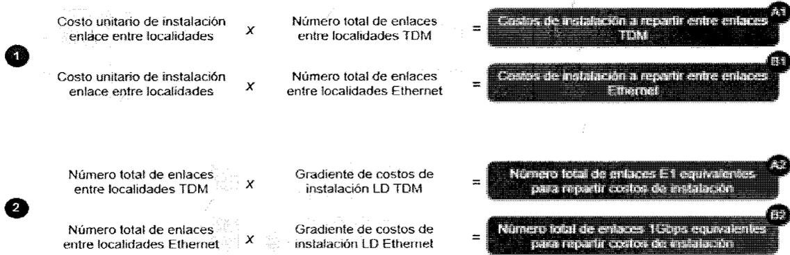
Partiendo de esta información se calcula el costo de instalación para los enlaces de referencia (E1 equivalente para TDM y T1/E3 equivalente para Ethernet) y a continuación se aplica un gradiente basado en los precios de instalación actuales de Telmex.
