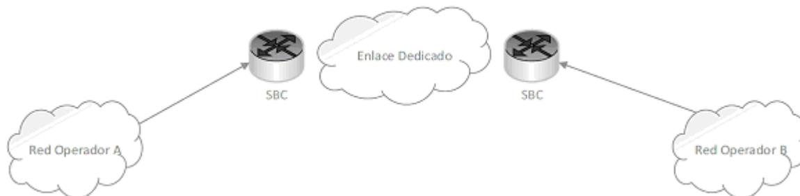
Figura 1: Topología de interconexión SBC-SBC
