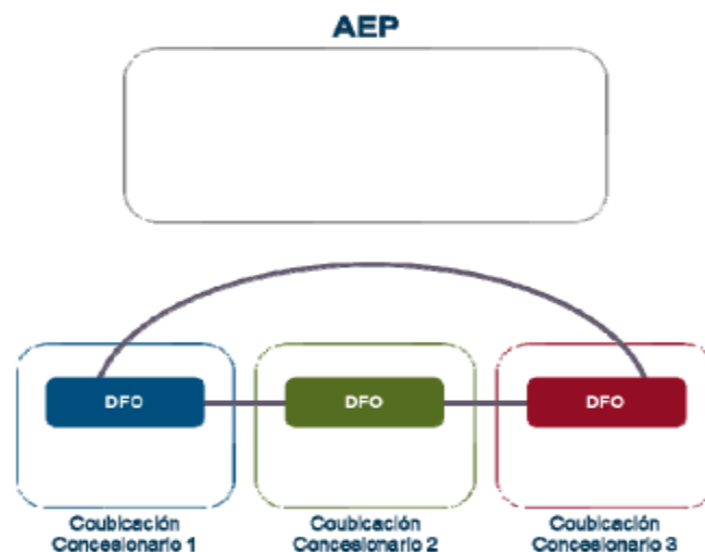
Figura. 11. Arquitectura servicio de interconexión cruzada pasivo.
