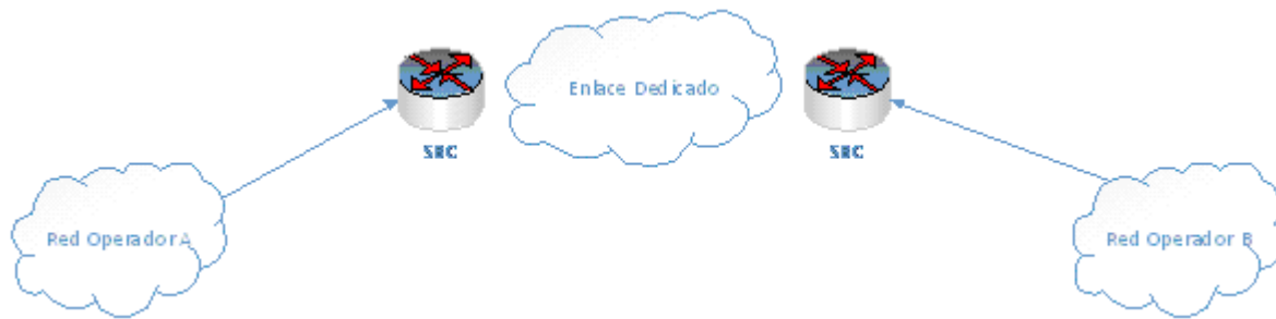
• Figura 1: Topología de interconexión SBC-SBC
