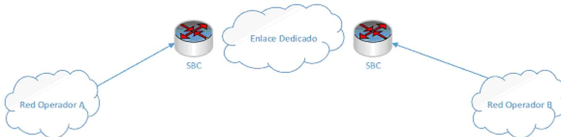
Figura 1. Topología de interconexión SBC-SBC
