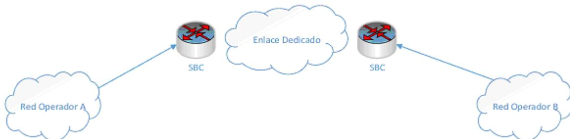
Figura 1: Topología de interconexión SBC-SBC
