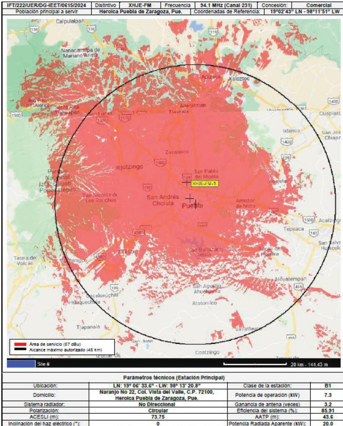
AATP, Altura del centro de radiación de la antena con relación al terreno promedio entre 3 y 16 km, calculada a 72 radios
