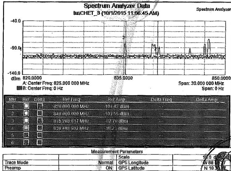
Gráfica donde se observan emisiones no esenciales que interfieren al rango de frecuencia de 820 a 840 MHz (delimitados por los marcadores 1 y 2), en específico en las frecuencias 835.268 y 839.408 MHz (indicadas en con los marcadores 3 y 4), originadas por un equipo para amplificar la señal de telefonía celular, el cual se encuentra dañado, esta muestra del espectro radioeléctrico se realizó con dicho equipo conectado a la toma de energía.
