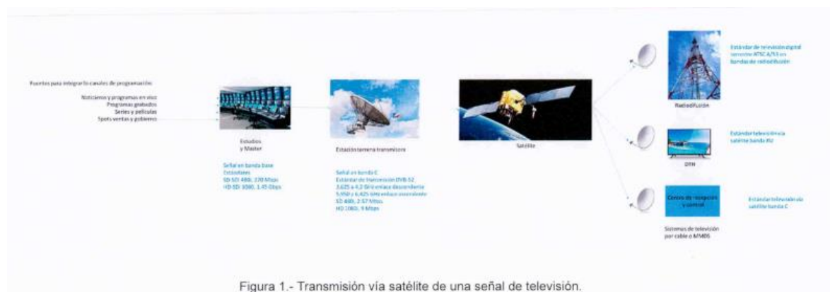
Figura 1.- Transmisión vía satélite de una señal de televisión.
