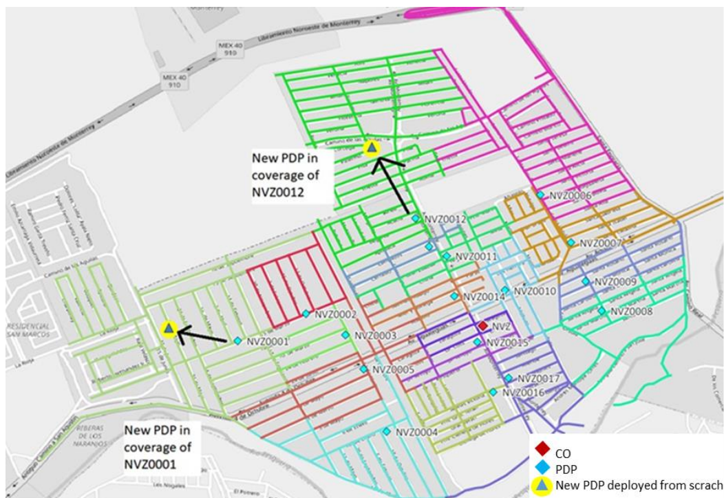
Figura 19 - Colocación de nuevos PDP con posición desconocida
