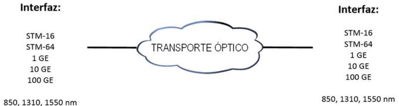
Figura 3 Arquitectura del servicio de canal óptico.
