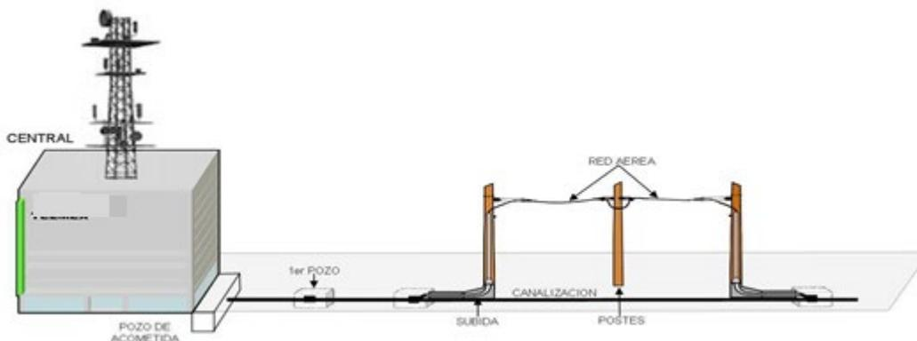
Figura 1 Edificio, Torre, y Obra Civil del AEP.
