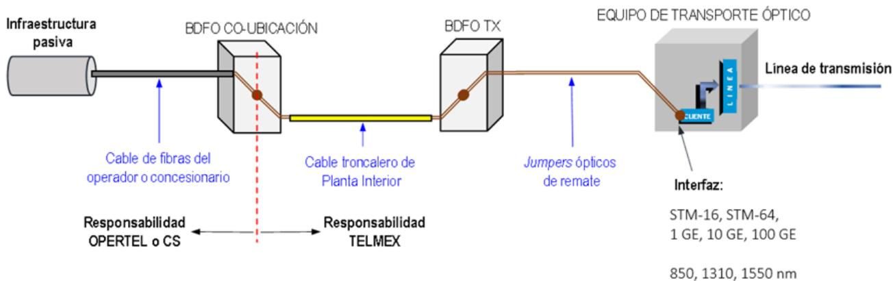
Figura 4 Conexión del servicio de canal óptico.
