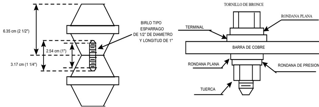
Tornillería en Barra de Cobre y entre Aisladores
