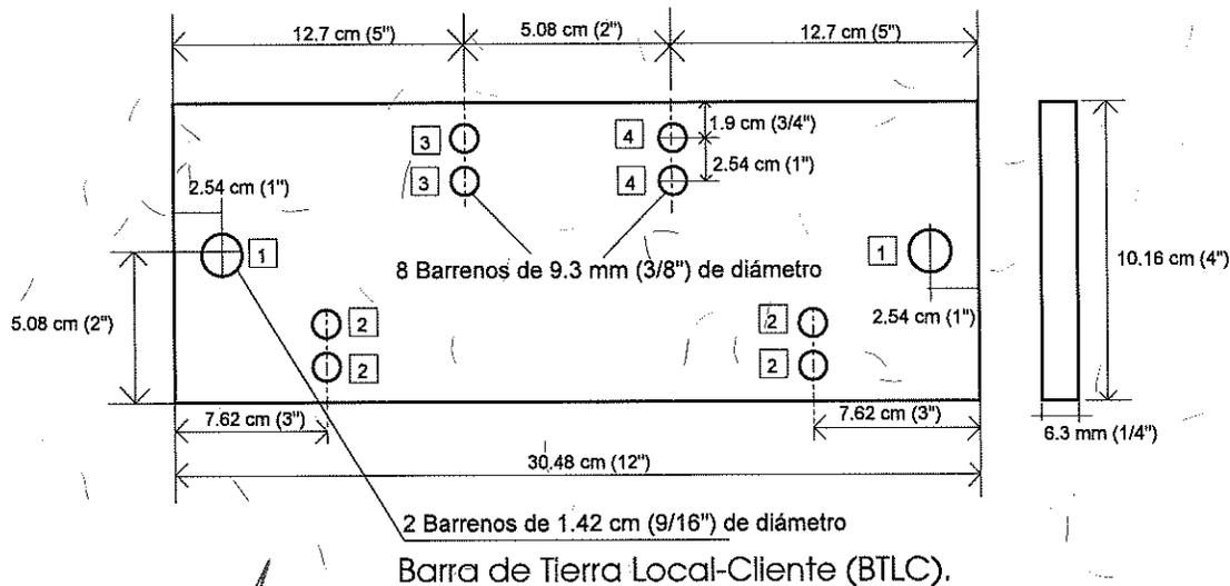
p. La barra de cobre que se utiliza para la puesta a tierra debe identificarse, según la terminología siguiente:
